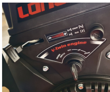
6 - Start maskinen Træk shoker ud Indstil gashåndtaget til halv styrke Drej nøglen Herefter sættes gashåndtaget til fuld styrke
