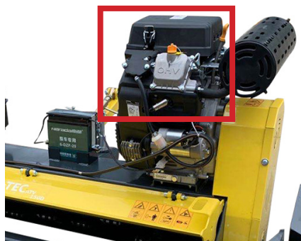
Påfyldning af motorolie, type SAE30
