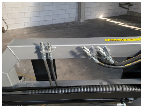
1 slangesæt til sideforskydning af grensav 1 slangesæt til vinkling af grensav 1 slangesæt til drift af savklinger Til fri retur hvis muligt.
