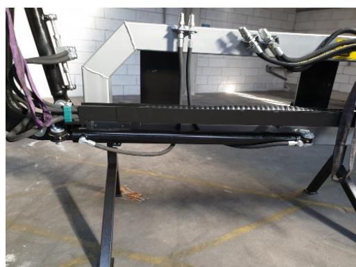
Hydraulik stempel til sideforskydning af grensaven
