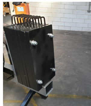
Vægtklodser til afbalancering af et grensaven for god balance
